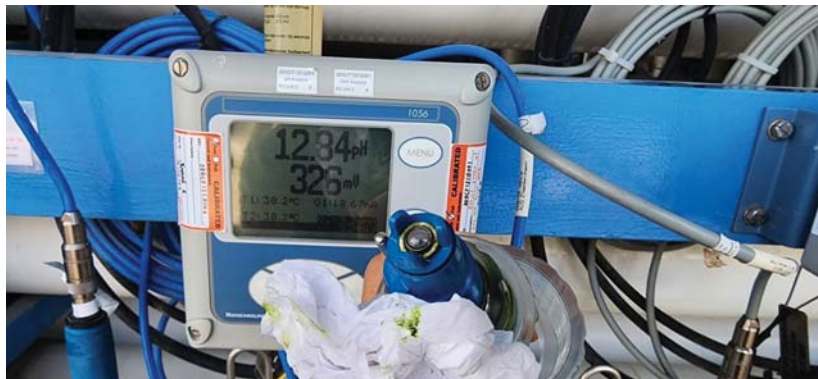
ภาพ แสดงการถอดหัวไฟรบบออกมาทำความสะอาดด้วยน้ำสะอาดและที่ชุบซับบริเวณหัววัด
