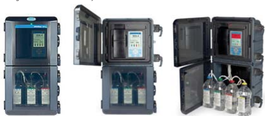
ภาพ แสดงลักษณะของเครื่องวัดซิลิกาในน้ำของบริษัท HACH ประกอบไปด้วย 3 Buffer เป็นสารที่ใช้ทำปฏิกิริยากับน้ำ Sampling เพื่อวัดค่าซิลิกา 1 Buffer สำหรับสารซิลิกาคงที่ใช้สำหรับสอบเทียบเครื่องวัด
