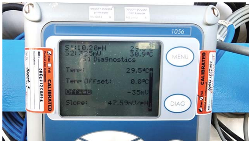
ภาพ แสดงค่า Offset และ Slope ของ pH หลังทำการสอบเทียบ
