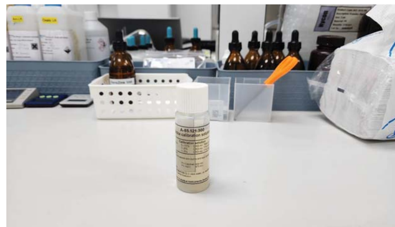
ภาพ แสดงน้ำยามาตรฐาน ORP 475mV สำหรับทำการสอบเทียบ
