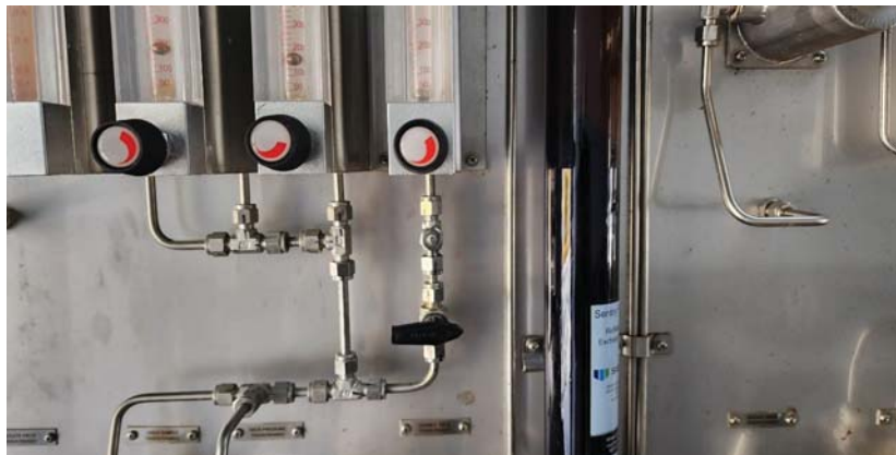
ภาพ แสดงการปรับสัณฐานเพื่อ น้ำ N2 เข้าระบบ เนื่องจาก N2 จะมีส่วนผสมของออกซิเจน ทำให้ค่าที่อ่านได้ต้องเท่ากับศูนย์
